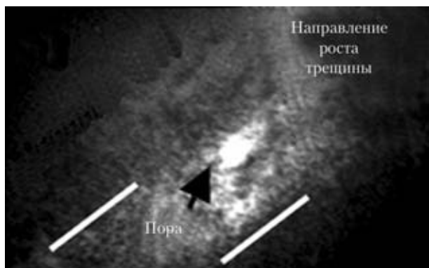
Рис. 9. Образование микропоры на линии сдвига перед вершиной трещины в образце из стали IN903, содержащем водород
