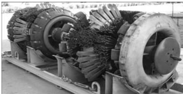
Рис. 5. Внутритрубный двухсекционный магнитный дефектоскоп поперечного намагничивания с байпасным устройством
