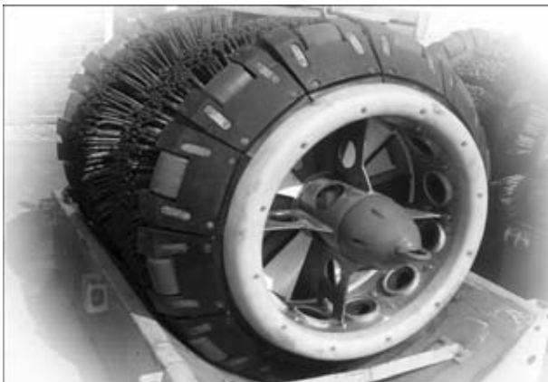
Рис. 2. Внутритрубный односекционный поршень магнитный очистной с байпасным устройством
