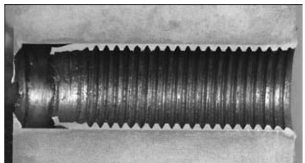
Рис. 5. Макрошлиф восстановленного резьбового отверстия
