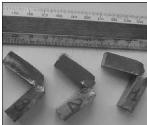
Рис. 4. Образцы металла модельного двухслойного слитка из стали типа 316 после испытаний на ударный изгиб
