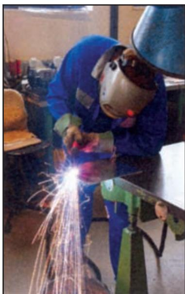
вождается образованием пыли. Для производителя мотоциклов KTM убедительным доводом в пользу этого метода являются повышение производительности и здоровая рабочая атмосфера. Удобный в обращении аппарат для резки и разделения от «Fronius», обладающий высокой мобильностью, не нуждается ни в подводе сжатого воздуха, ни в использовании компрессора или больших, тяжелых газовых баллонов.
