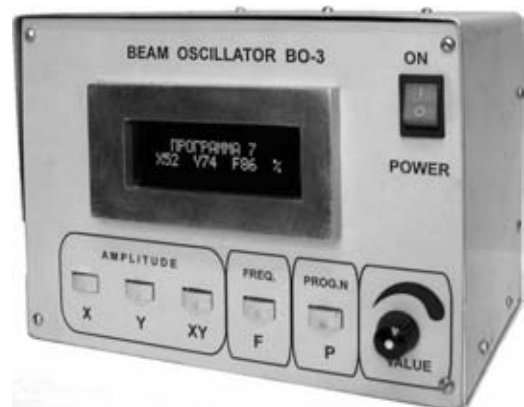
Рис. 2. Внешний вид контроллера развертки электронного пучка для сварки
