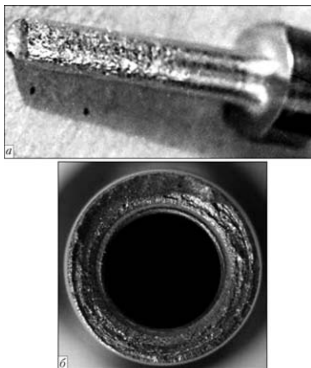
Рис. 5. Характер поверхностей разрушения сварных образцов цилиндров (а) и втулок (б)
