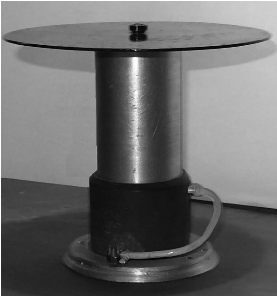
Рис. 3. Вид короткого вибратора с емкостной нагрузкой в виде диска
