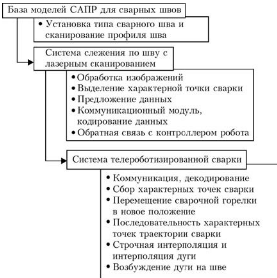
Рис. 8. Блок-схема алгоритма телеобучения с помощью LSVS
