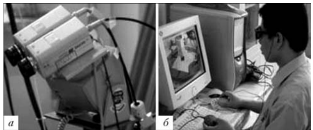
Рис. 4. Стереоскопические камеры с подвесной головкой (а); работа оператора в режиме прямого ручного управления с использованием стереоскопического дисплея (б)
