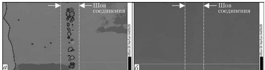
Рис. 1. Микроструктурная ориентация соединения монокристалла DD3 с ПЖФ: а — исходное состояние; б — монокристаллическое соединение
