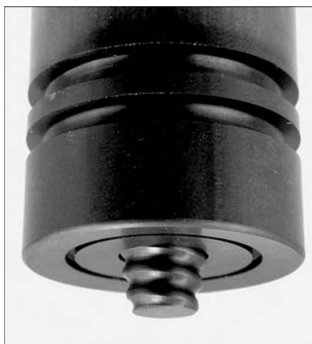
Рис. 8. Рабочий инструмент для сварки трением с перемешиванием стальных труб
