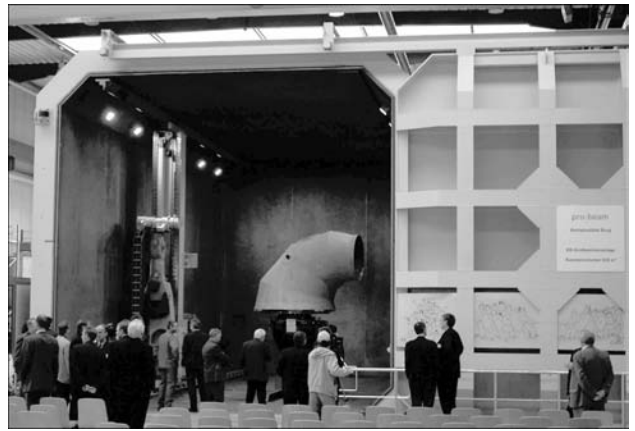
Рис. 6. Вакуумная камера для электронно-лучевой сварки крупных изделий
