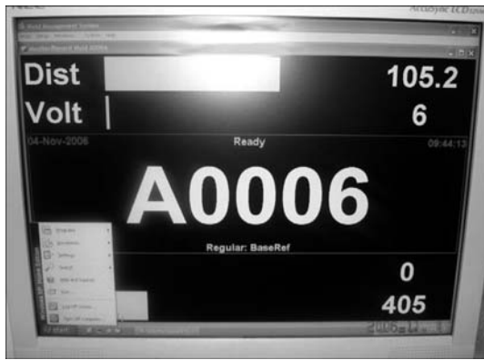
Рис. 6. Интерфейс системы компьютерного контроля параметров и оценки качества сварки
