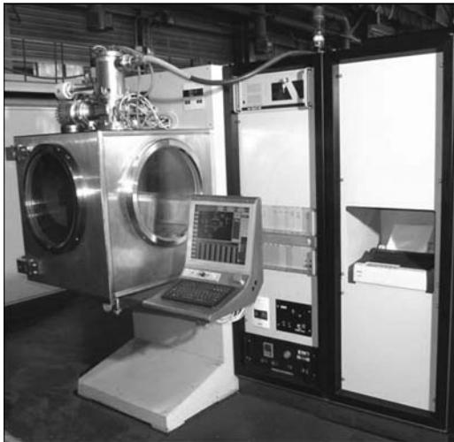
Рис. 7. Установка СВ-112 для сварки малогабаритных изделий (в промышленной эксплуатации находится семь таких установок)
