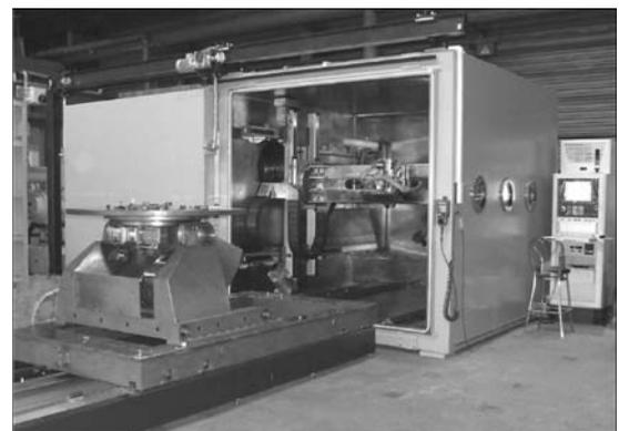
Рис. 11. Установка КЛ-132 с семикоординатной системой сварочных перемещений для изготовления изделий аэрокосмической промышленности
